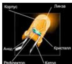
Рис. 1. Принципиальная конструкция современного светодиода.
